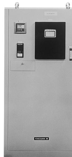
Газовый калориметр и измеритель плотности
