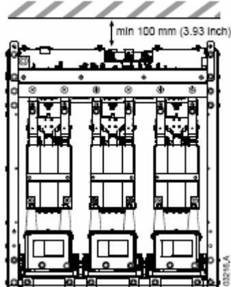
Силовой узел монтируется и закрепляется четырьмя болтами M12, расположенные по углам основания узла. Болты затягиваются с усилием 40 Н\*м. Каждая фазная стойка крепится внутри силового узла тремя болтами M10 с усилием затяжки 17 Н\*м.
