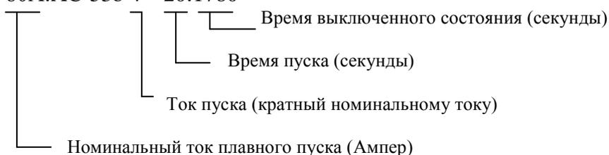
*Номинальный ток плавного пуска:* полный номинальный ток устройства плавного пуска.
