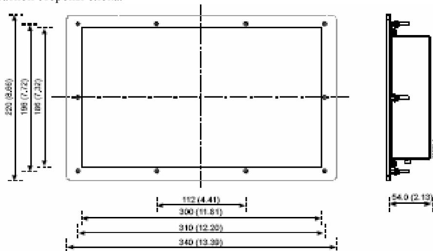
Отверстие под монтаж блока управления (186 x 300) мм. С обратной стороны плоскости монтажа должно быть не менее 54 мм в глубину для свободного размещения блока.
