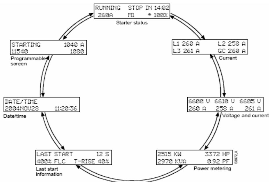
Нажатие клавиши ▲ в экране просмотра даты и времени вызовет экран для установки даты и времени. Нажатие клавиши ▲ в любом другом экране откроет меню программирования.
