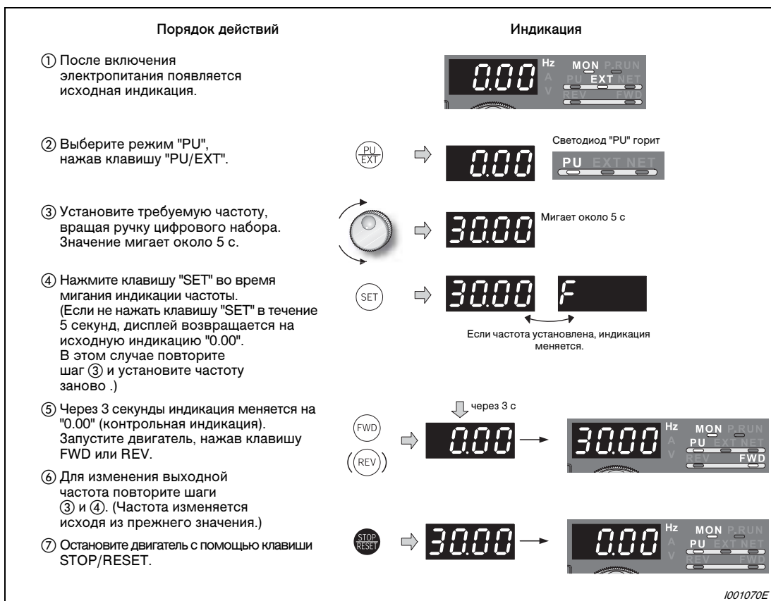
Рис. 5-17: Настройка частоты с помощью ручки цифрового набора
