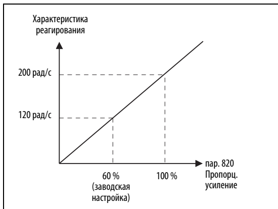
Рис. 6-16: Настройка пропорционального усиления
