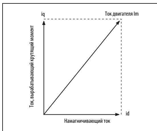
Рис. 6-2: Компоненты тока двигателя
