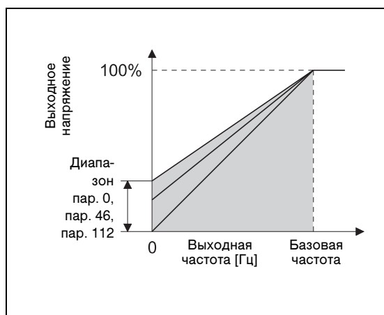
Рис. 5-3: Взаимосвязь выходной частоты и выходного напряжения
