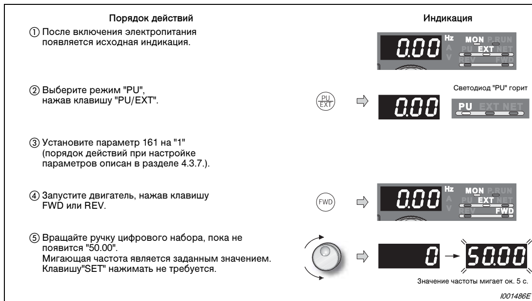
Рис. 5-18: Изменение выходной частоты во время работы
