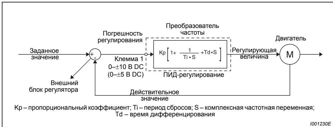
Рис. 6-137: Конфигурация системы для парам. 128 = 10, 11 (Применение внешнего блока ПИД-регулятора)
