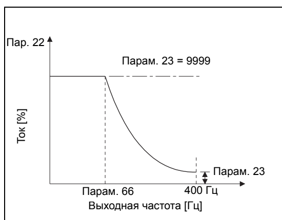
Рис. 6-4: Характеристика предельного значения тока
