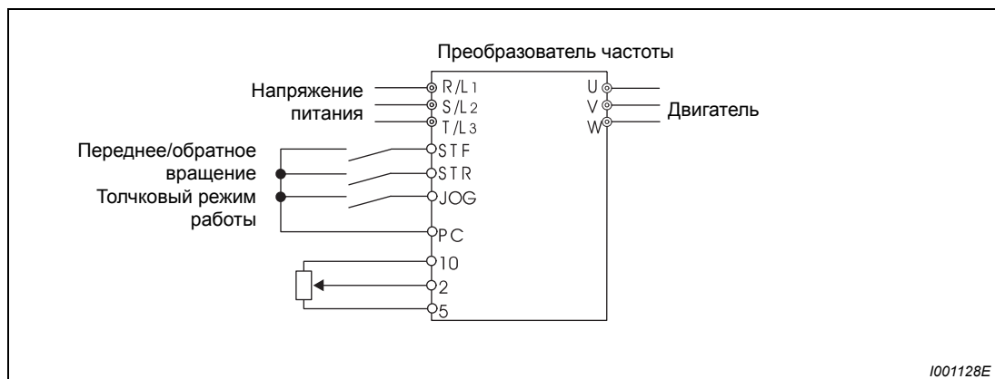
Рис. 6-20: Пример подключения для толчкового режима работы при внешнем управлении
