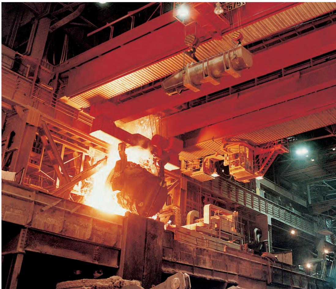
Загрузочный кран, Разливка из дуговой печи
