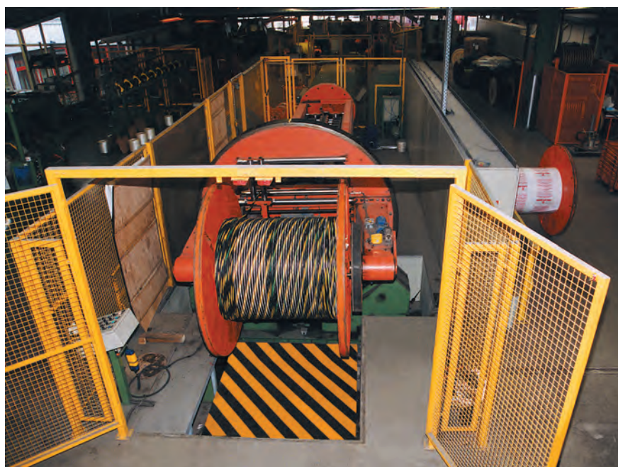
Большая машина для изготовления кабеля до 4 x 185 мм 2 на заводе Windsbach.
