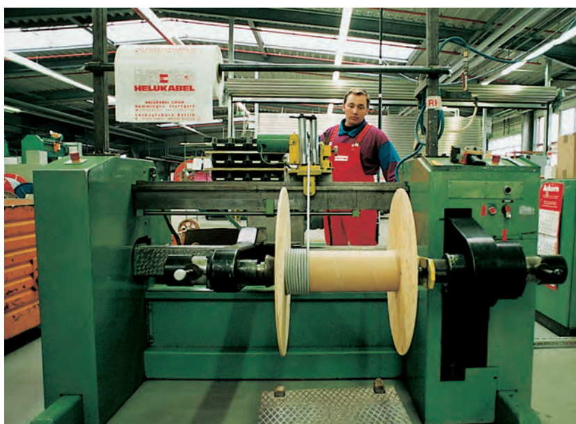
Процесс намотки на заводе Windsbach
