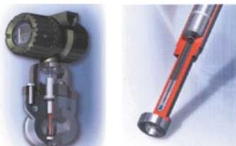
Рис. 17. Многопараметрический вихревой расходомер и тело обтекания со встроенным термосопротивлением Pt1000
