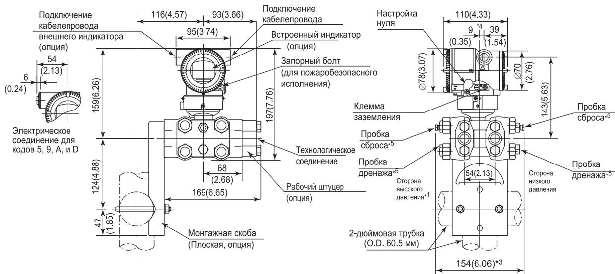
\*1: Если выбран код монтажа 8, то расположение сторон высокого и низкого давления противоположно показанному на рисунке (т.е. сторона высокого давления находится справа).
